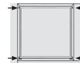
**NO:** Vannavrenning fra vinduet må utføres forskriftsmessig i henhold til Byggforsk detaljblad. Vindspærre mellom karm og vegg må utføres forskriftsmessig før isolering i mellomrommet karm/vegg i henhold til Byggforsk detaljblad.
