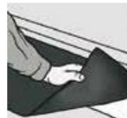
**SV:** Om underlaget är betong måste en fuktspärre placeras under tröskeln, t ex. tjärepapp.
