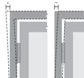
**SE:** Fast skruvarna p  g ngj rnsidan. Lyft in d rrbladet i g ngj rnen och kontrollera att d ren st ngs. Om inte kan ram en justeras. Dra  t eller l sna toleransd rrkarmen p  g ngj rnsidan tills d ren fungerar korrekt, montera skruvar p  l ssidan. Ta sedan bort kilarna i topp och botten.
